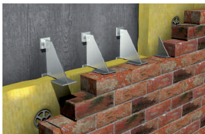
Mocowanie płyt izolacyjnych w ścianie szczelinowej trójwarstwowej
