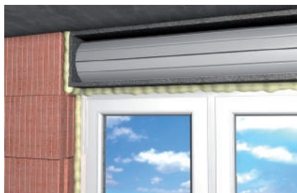
Osadzanie i uszczelnianie ościeżnic okiennych
